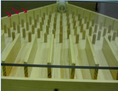
Obr.9: Pohľad do otvorenej Galtonovej dosky. Na obrázku je zariadenie bez spodnej vyberateľnej priečky. Šípky naznačujú špajdle, ktoré sme do zariadenia dolepili.
