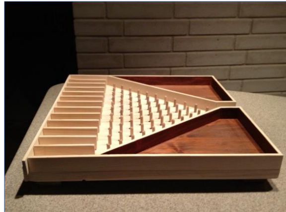
Obr.6: Galtonova doska vo fáze výroby. Už po vyvrtaní dier na kolíky, prilepení priečok a latiek na umožnenie pohybu guľôčky len v priestore, kde sú kolíky.
