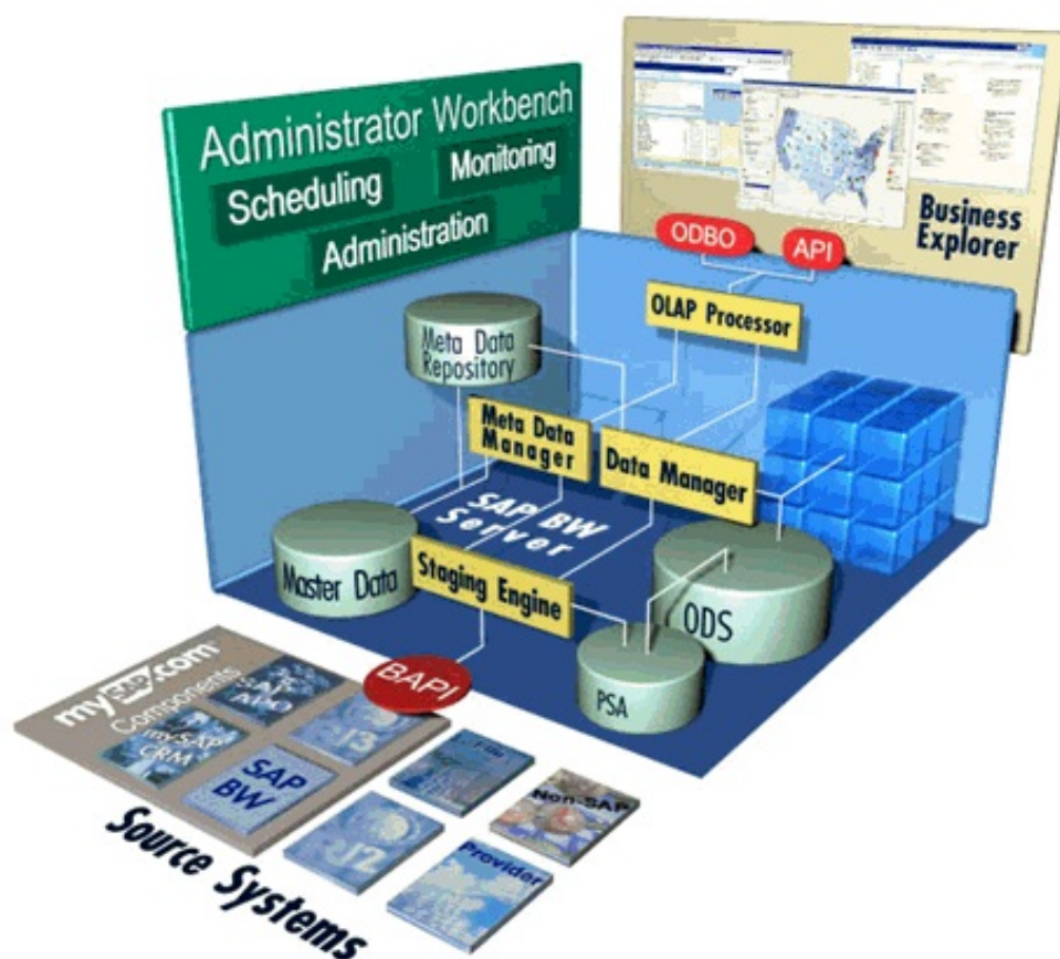
Obr. 5.1: Architektúra SAP BW, zdroj [25]
